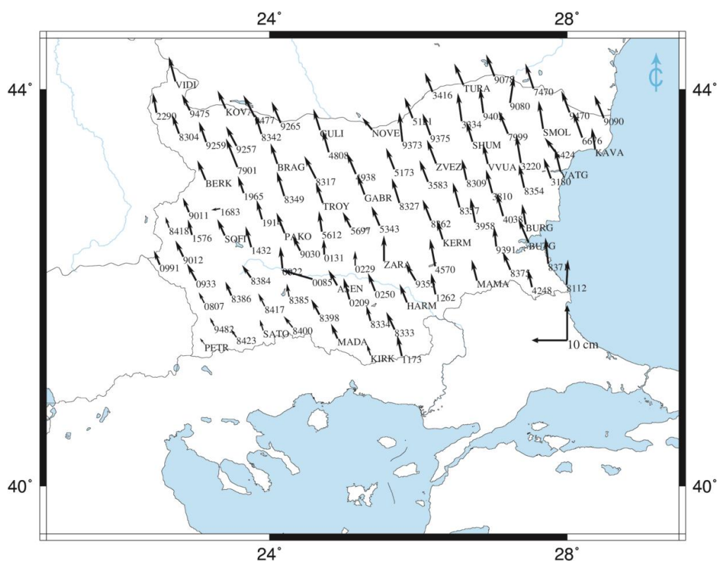
Фигура 15 Разлики по положение между новополучените координати, в реализация ETRF2014 епоха 2020.0 и официалните, реализация ETRF2000 епоха 2005.0
