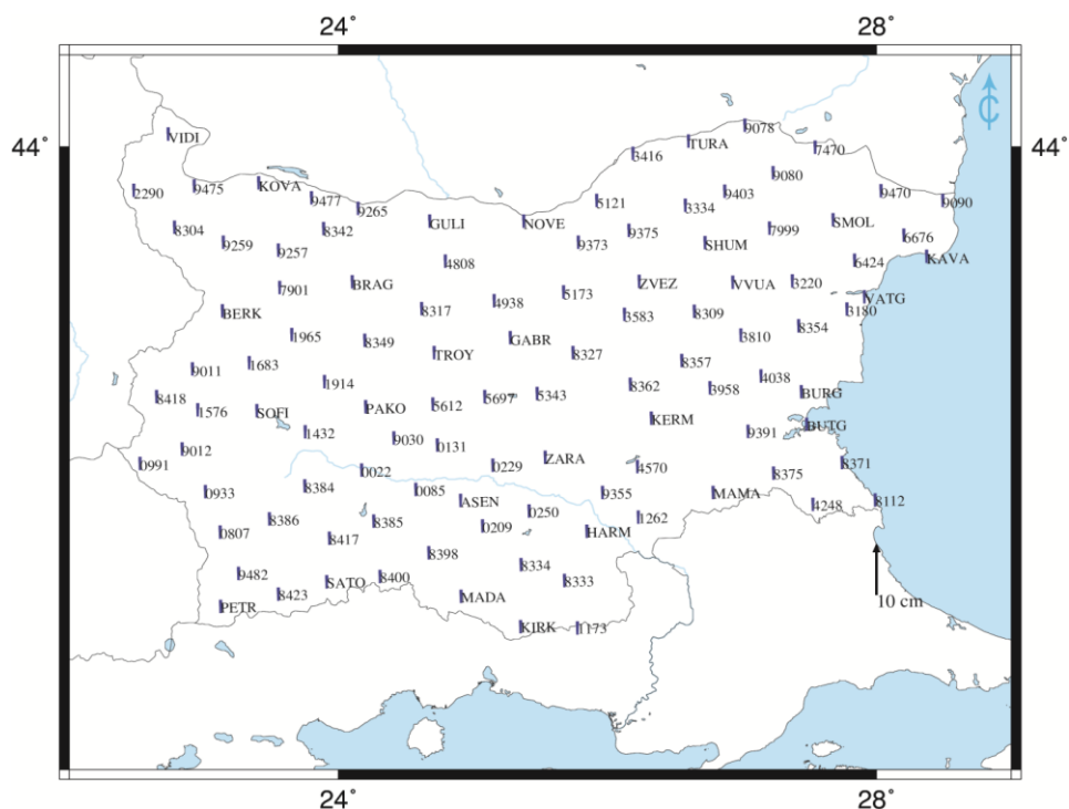
Фигура 14 Разлики във височина между новите координат в ETRF2014, епоха 2005.0 и официалните в ETRF2000, епоха 2005.0
