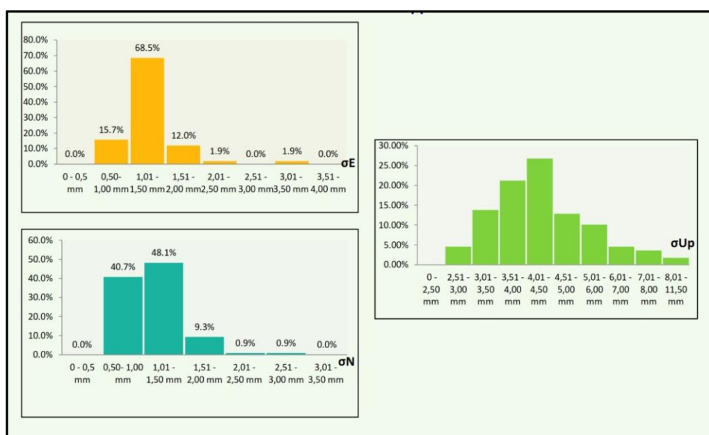
Фигура 8 Разпределение на средните грешки по положение (компоненти изток, север и височина)
