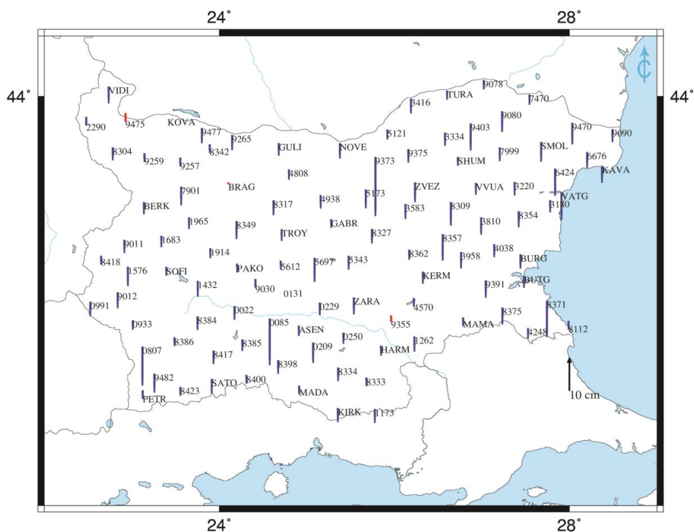
Фигура 16 Разликите във височините между новополучените координати в ETRF2014, епоха 2020.0 и официалните в ETRF2000 епоха 2005.0.
