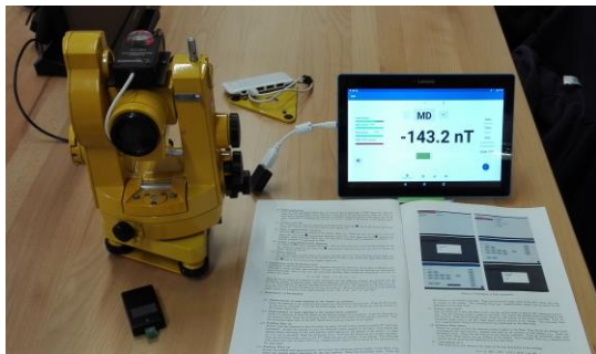
FLUXSET© магнитометър монтиран на немагнитен теодолит THEO 010B с радиовръзка (Mingeo Ltd.)
