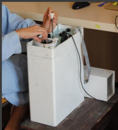
Магнитометър Molspin Minispin ( Molspin Ltd., UK ) за измерване на носената остаъчна намагнитеност
