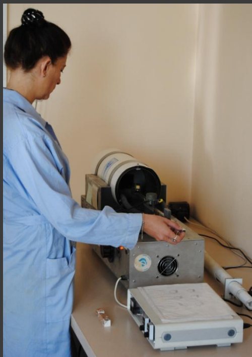
Размагнитващо устройство Molspin MSA2 (Molspin, Ltd., UK) за измерване на носената остатъчна намагнитеност
