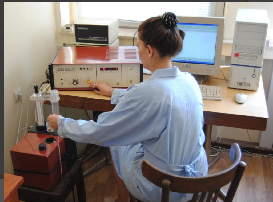
Капа-мост за измерване на магнитната възприемчивост KLY-2 ( AGICO, Inc., Brno )
