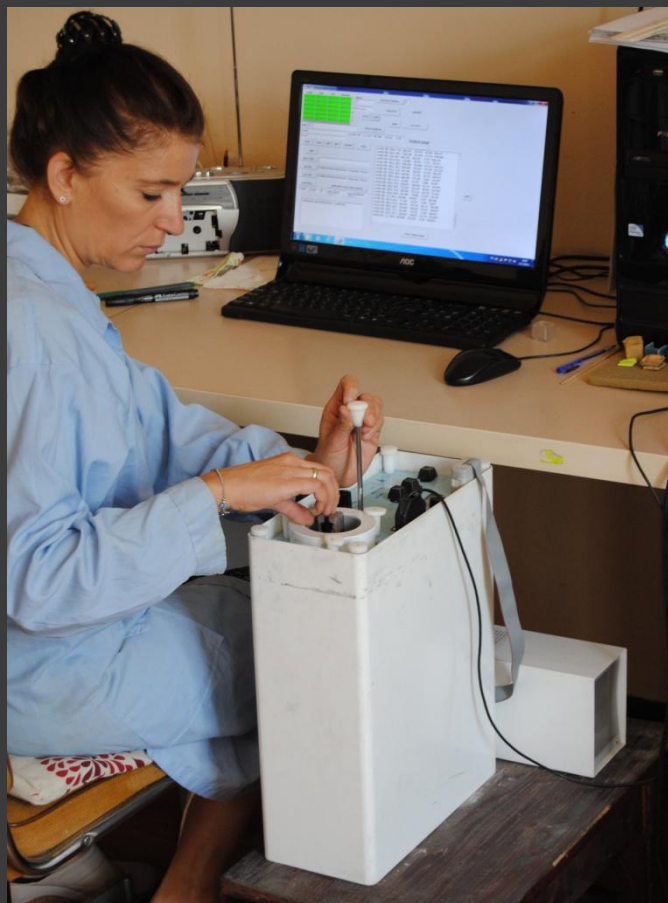
Магнитометър Molspin Minispin ( Molspin, Ltd., UK ) за измерване на носената остатъчна намагнитеност
