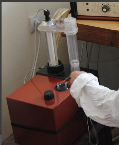
Капа-мост за измерване на магнитната възприемчивост KLY-2 с високотемпературна приставка CS-23 ( AGICO, Inc., Brno )
