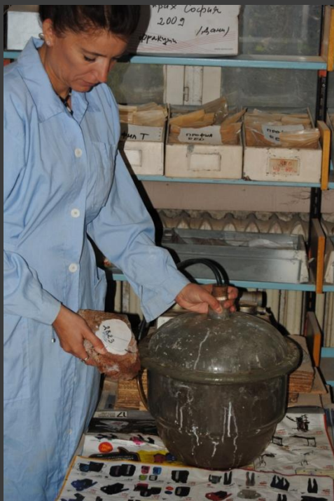
Ексикатор SIMAX за импрегниране на образците с водно стъкло
