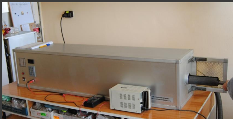
Екранирана немагнитна пещ MTMD ( Magnetic measurements Ltd., UK ) за температурно размагнитване и лабораторно индуциране на термоостаъчна намагнитеност
