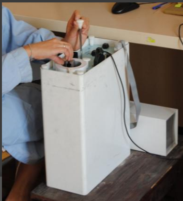
Магнитометър Molspin Minispin (Molspin Ltd., UK) за измерване на носената остатъчна намагнитеност
