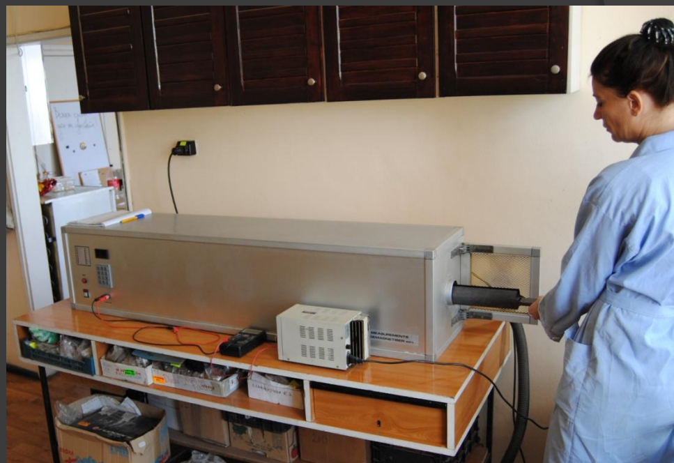
Екранирана немагнитна пещ MTMD (Magnetic measurements Ltd., UK) за температурно размагнитване и лабораторно индуциране на термоостатъчна намагнитеност
