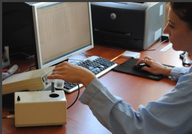
Капа-метър ( Bartington Inc. ) за измерване на магнитната възприемчивост при две честоти на променливо магнитно поле
