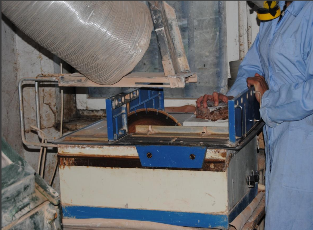
Настолна шлифовъчно-режеща машина MINOSEKAR-2 , с въртящ се диамантен диск
