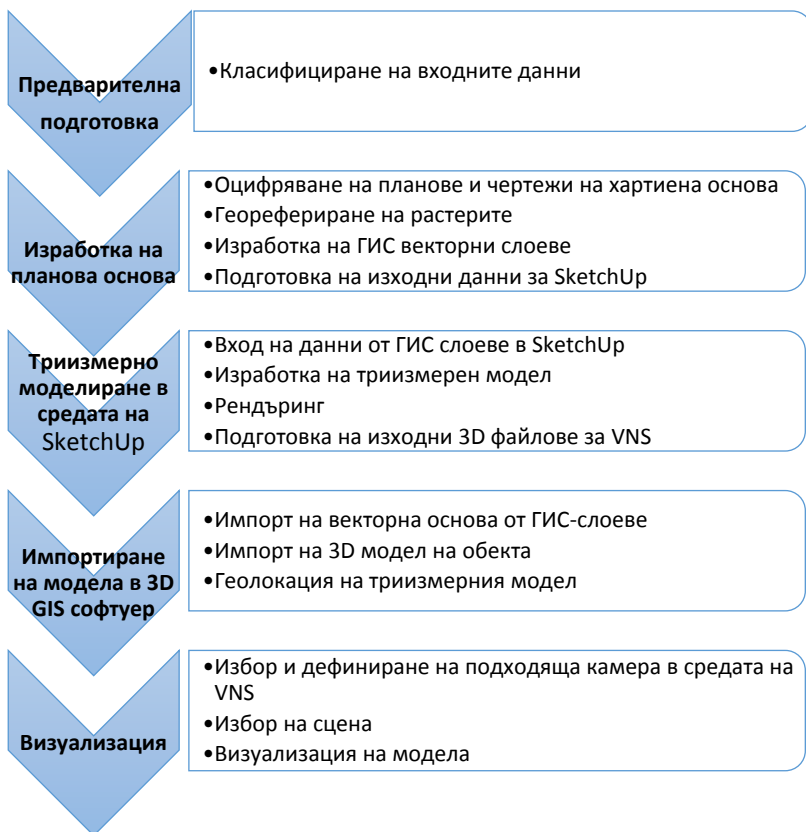
Фигура 4.4-2. Схема на работния процес за триизмерно моделиране на тестов обект "Посетителски център - Враца"
