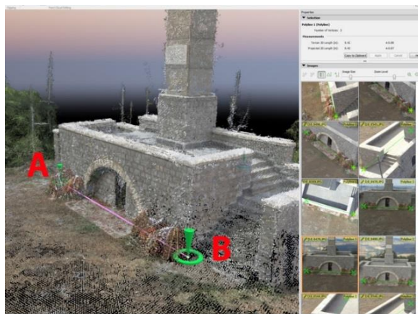
Фигура 4.2-13. Изображение на построена линия A-B в средата на Pix4D
