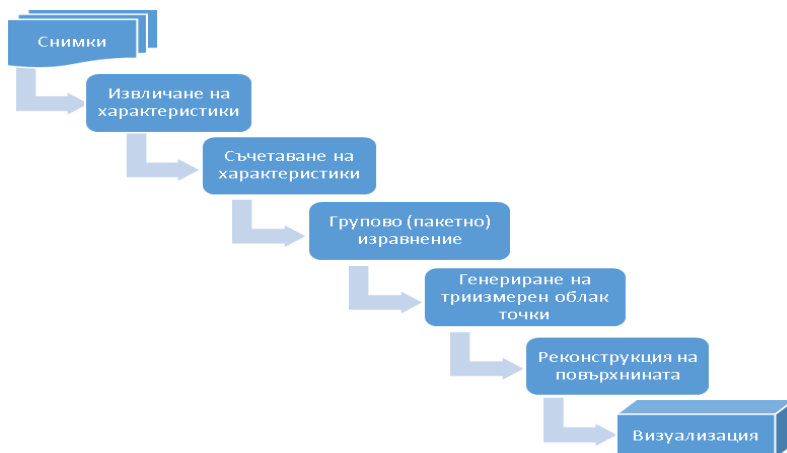
Фигура 2.4-3. Общ работен процес за цифрова фотограметрия чрез SfM-метод
