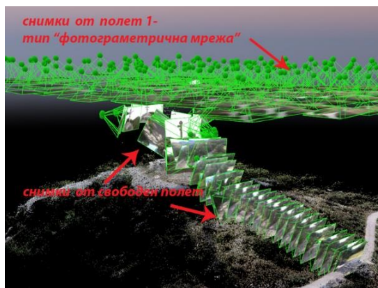
Фигура 4.2-6. Пространствено положение на камерата със заснетите кадри, визуализиран
