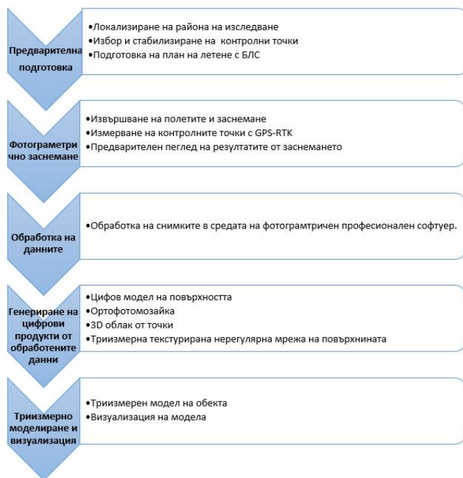
Фигура 2.5-4. Работен процес за триизмерно моделиране чрез използване на БЛС
