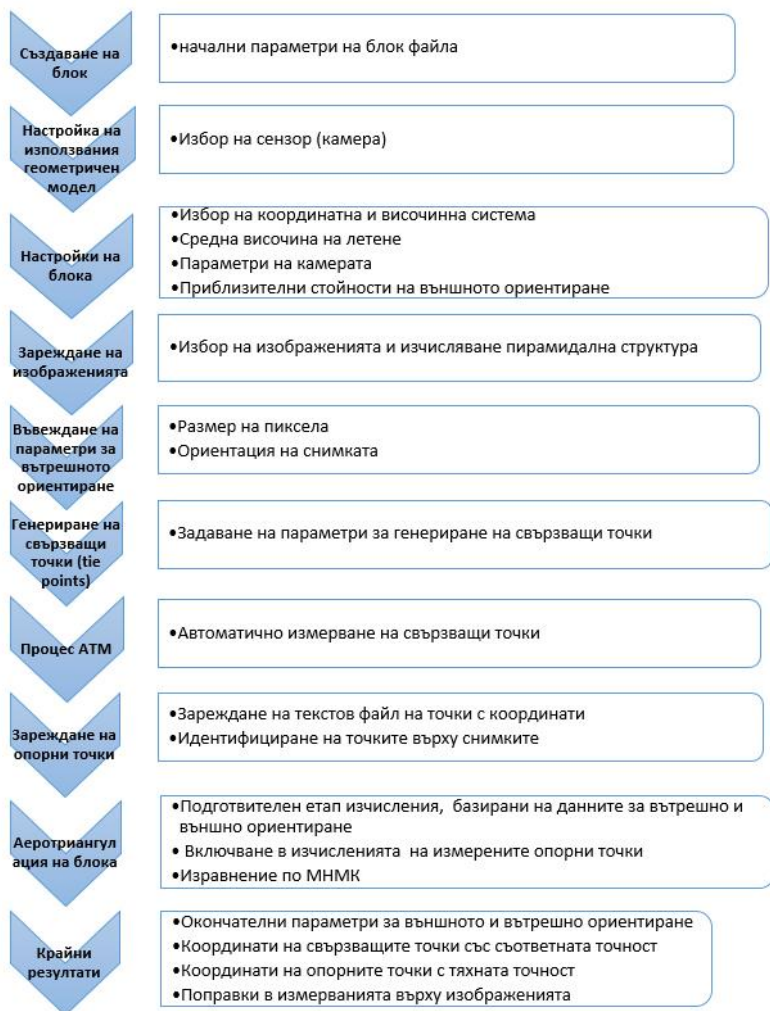
Фигура 2.3-2. Работен процес за фотограметрична обработка с LPS на Erdas Imagine
